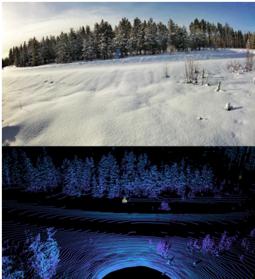
Rinnakkainen kamera-LiDAR -mittaus sääriippuvuuden määrittämiseen. Ylemmän kamerakuvan liikennemerkit infrapunateipattu, näkyvät alhaalla olevassa LiDAR-kuvassa keltaisena.
