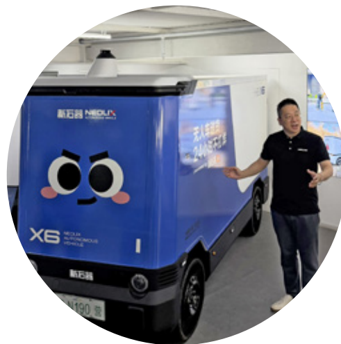
Neolix X6 on tason 4 autonominen jakeluajoneuvo, jota mm. Ikea käyttää kotinkuljetuksissa.
