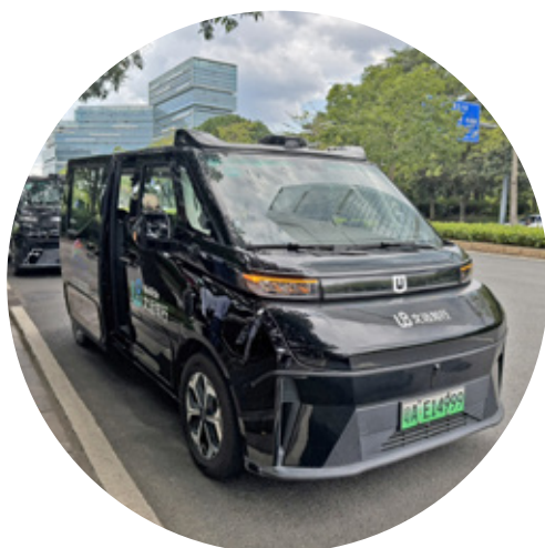
WeRiden robotitaksi GXR Guangzhoun katu-kuvassa: yli 20 anturia, L4-tason autonomia ja maailman tilavimmiksi mainostetut sisätilat.
